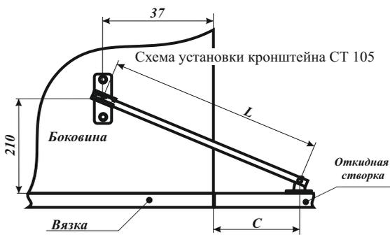
*Размер C определяется углом открытия*
